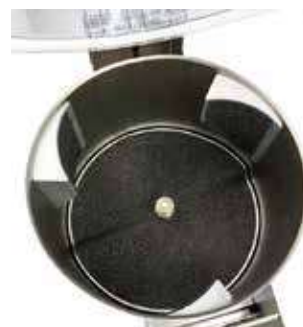
Revolvedores laterales y plato abrasivo.
