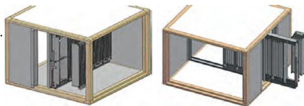
Filtro en caja con embocadura
